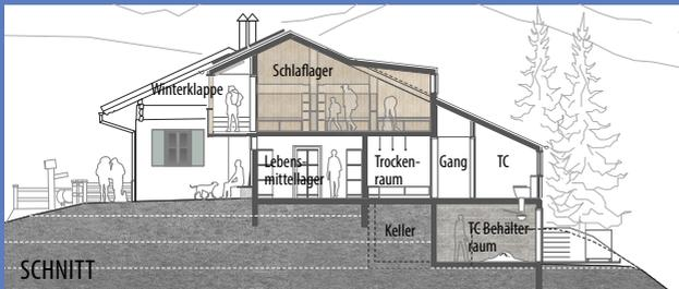
Wir planen ein Trocken-Trenntoilettensystem (TC), um den Wasserverbrauch grundsätzlich zu reduzieren. Der Sanitärbereich wird rückseitig und dadurch entfernt genug vom Terrassenbereich angeordnet.
