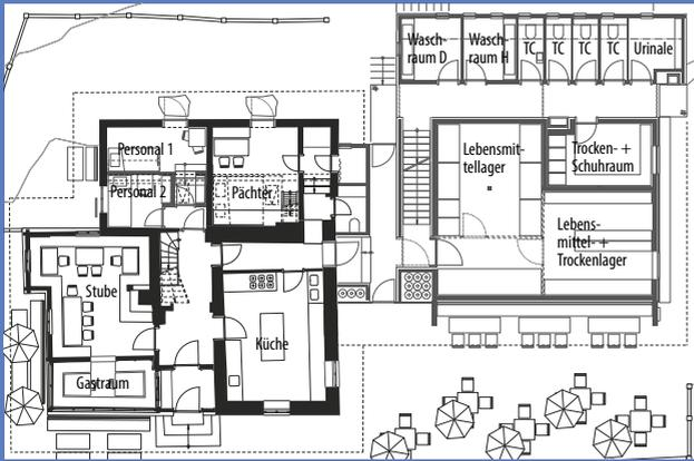
Die versetzte Anordnung der Gebäudeteile bleibt bestehen, damit der geschützte Terrassenbereich aufgewertet wird. Der Laubengang erschließt die kleineren Zimmereinheiten von außen. Mehrere „Winterklappen“ schützen das Gebäude im Winter (siehe unten).
